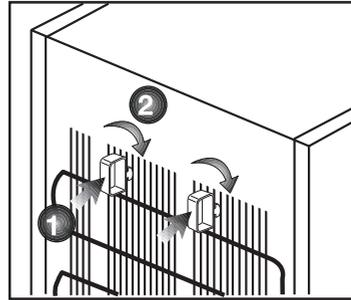
für den richtigen Abstand zwischen Kühlschrank und Wand – und damit für die richtige Luftzirkulation. (Die Abbildung dient lediglich zur Orientierung und muss nicht exakt mit Ihrem Gerät übereinstimmen.)
