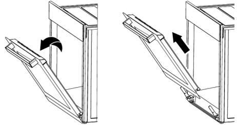
8. Ziehen Sie die entriegelte Tür nach oben, um sie aus dem rechten und linken Scharnier zu lösen und zu entfernen.
