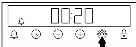
⇒ Nach der Einstellung der Alarmzeit bleibt das Symbol weiterhin beleuchtet und die Alarmzeit startet den Countdown der Anzeige. Wenn die Weckzeit und die Backzeit zur gleichen Zeit eingestellt werden, wird die kürzere Zeit auf der Anzeige angezeigt.
