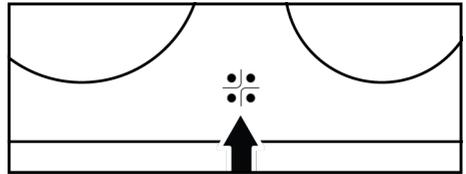
Die Warnanzeige für die heiße Zone zeigt die Position des eingeschalteten Kochfelds an und leuchtet nach dem Ausschalten weiter. Ein flackerndes Licht auf der Warnanzeige für die heiße Zone ist keine Fehlfunktion.
