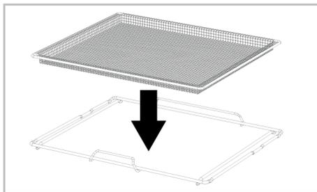
Setzen Sie den Bratrost so in den Ofen, dass der kurze Griff nach vorne zeigt.
