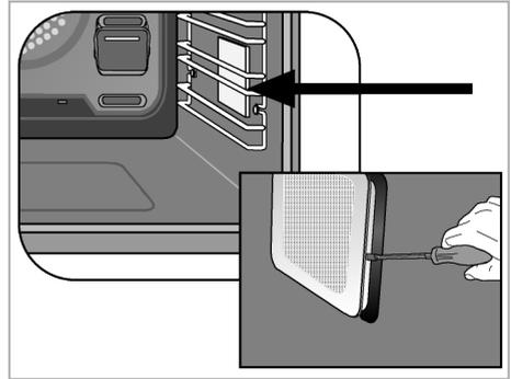
3. Heben Sie die Glasabdeckung des Leuchtmittels mit einem Schraubendreher an. Entfernen Sie zuerst die Schraube, wenn in Ihrem Produkt eine Schraube an der quadratischen Lampe vorhanden ist.
