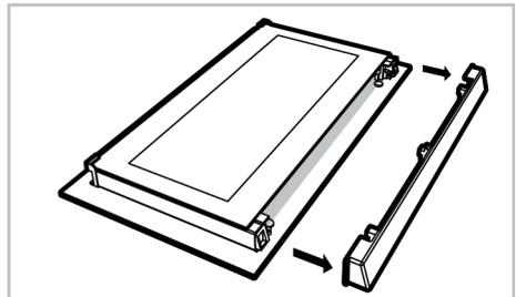
3. Heben Sie, wie in der Abbildung gezeigt, das innerste Glas (1) vorsichtig in Richtung „A“ an und entfernen Sie es dann, indem Sie es in Richtung „B“ ziehen.
