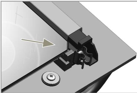
Der erste Schritt bei der Neugruppierung der Tür besteht darin, das zweite und dritte Glas wieder einzusetzen (2, 3). Platzieren Sie, wie in der Abbildung gezeigt die abgeschrägte Kante des Glases so, dass sie auf die abgeschrägte Kante des Plastikschlitzes trifft.
