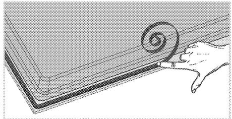
3. Befestigen Sie die Montagefedern, stecken Sie sie wie abgebildet durch die Löcher am unteren Gehäuse und schrauben sie fest.
