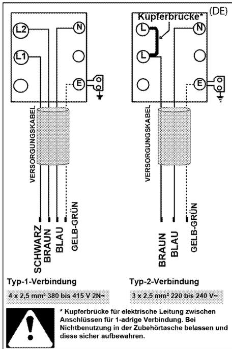
2. Bei **Einphasenanschluss** erfolgt der Anschluss der Kabel wie folgt:
