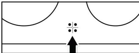
Die Warnanzeige für die heiße Zone zeigt die Position des eingeschalteten Kochfelds an und leuchtet nach dem Ausschalten weiter. Ein flackerndes Licht auf der Warnanzeige für die heiße Zone ist keine Fehlfunktion.
