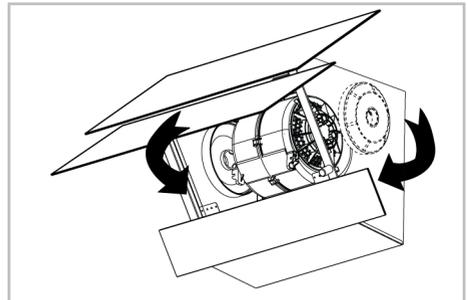
4. Schließen Sie die Glasabdeckung der Dunstabzugshaube nach dem Einbau des Aluminiumfilters.
