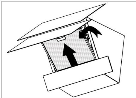
3. Setzen Sie den Metallfettfilter nach dem Spülen wieder in seinen Schlitz ein, indem Sie die obigen Schritte in umgekehrter Reihenfolge ausführen.
