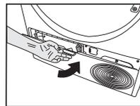
Setzen Sie nach Abschluss des Reinigungsvorgangs die Luftleitblechabdeckung an ihren Platz, bewegen Sie die Riegel, um sie zu schließen, und schließen Sie das Bordbrett.
