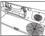
Bewegen Sie die Riegel, um den Luftleitblechdeckel zu öffnen.
