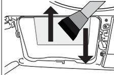
Reinigen Sie die Faser auf der Metalloberfläche des Kondensators mit einem feuchten Tuch oder der Bürste am Luftleitblech nach oben und unten. Reinigen Sie nicht von links nach rechts, da dies die Metallplatten des Kondensators beschädigen kann. Sie können einen Staubsauger mit einer Bürste zum Reinigen verwenden. Wenn der Staubsauger keine Bürste hat, wird nicht empfohlen, ihn für die Kondensatorreinigung zu verwenden.
