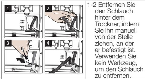
3 Führen Sie ein Ende des mit dem Trockner gelieferten Wasserablaufschlauchs an der Stelle ein, an der Sie den Schlauch an der Trockner entfernt haben.
