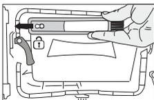
Ziehen Sie die Bürste nach links, um sie zu entfernen. Mit der Reinigungsbürste können Sie Filter, kondensierende Metalloberfläche und angesammelte Fasern an der Tür reinigen.
