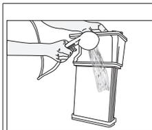
Reinigen Sie den Kondensator unter einem kräftigen Wasserstrahl (z. B. mit dem Duschkopf), lassen Sie das Wasser komplett ablaufen.
