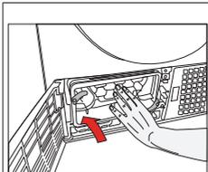
Setzen Sie den Kondensator wieder in das Gehäuse ein. Schließen Sie die beiden Sperren, achten Sie darauf, dass diese fest sitzen.
