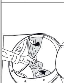
Entfernen Sie die Transportsicherungen, bevor Sie das Gerät zum ersten Mal benutzen. Wenn die Klappenrichtung Ihres Produkts änderbar ist, lesen Sie die Montageanweisung für reversible Klappen, die mit Ihrem Produkt geliefert wurde.
