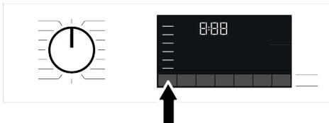
Sobald Sie ein neues Programm auswählen, wird die für das jeweilige Programm empfohlene Waschtemperatur in der Temperaturenanzeige angezeigt. Möglicherweise ist die empfohlene Temperatur nicht die Maximaltemperatur, die beim aktuellen Programm ausgewählt werden kann.
