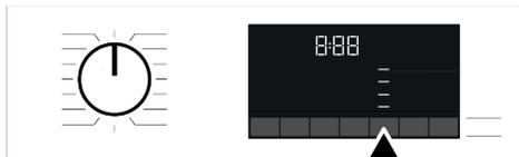
Bei der Auswahl eines neuen Waschprogramms stellen Sie die für das Programm geeignete Trocknungsfunktion mit der Zusatzfunktionstaste ein.
