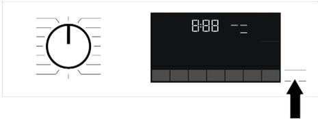
Falls der Wasserstand in der Maschine bei Betätigung der Taste Start/Pause zu hoch ist, kann die Türsperre nicht deaktiviert werden und das Türverriegelungssymbol im Display bleibt eingeschaltet.
