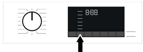
Nachdem ein Programm ausgewählt wurde, wird die empfohlene Schleuderdrehzahl des gewählten Programms in der Anzeige Schleuderdrehzahl dargestellt. Möglicher-
