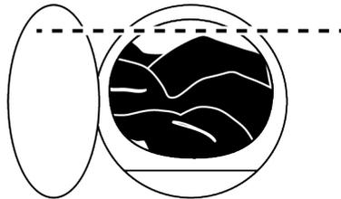
Im 5 kg Wasch- und 5 Trocknungsprogramm wird empfohlen, die Maschine für ideale Trocknungsbedingungen bis zu dem oben angegebenen Niveau zu beladen (Sie sehen den Füllstandspfeil, wenn Sie die Ladetür öffnen).
